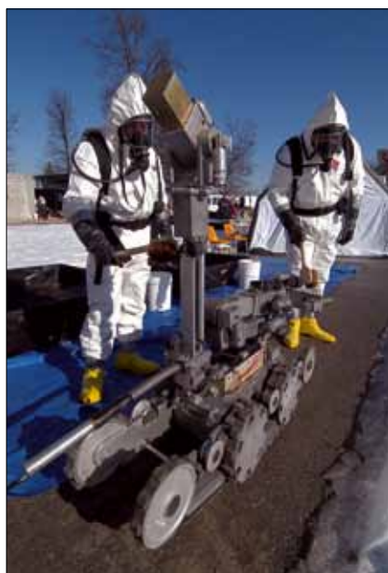
Dekontaminacija robota po uporabi
