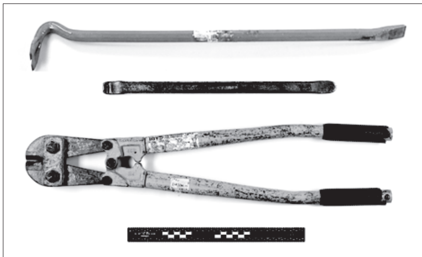
Slika 4: Orodje za poškodovanje ključavnic obešank
