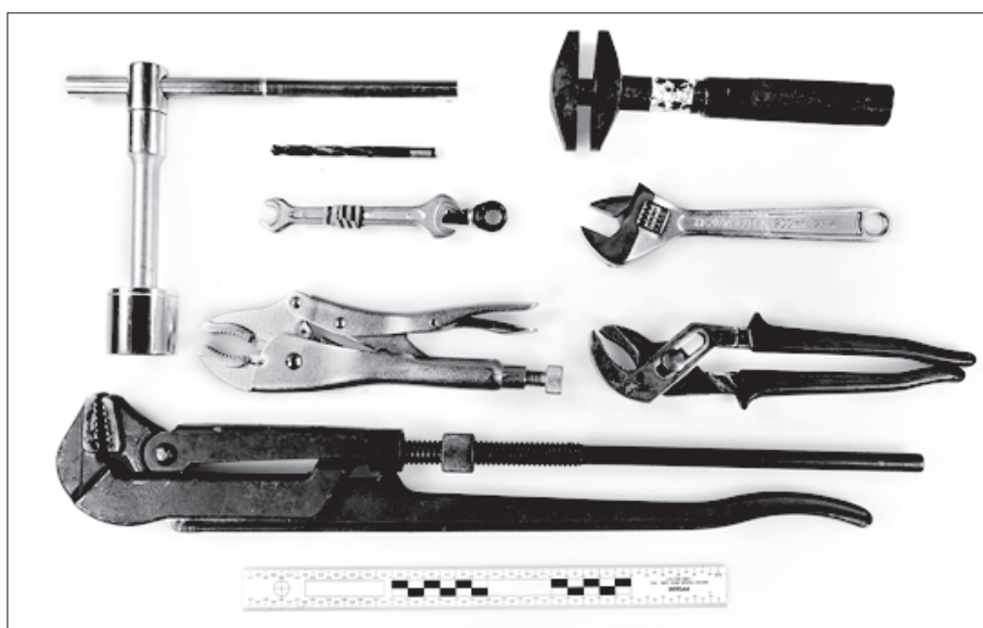
Slika 1: Ročno orodje za lomljenje cilindričnega vložka ključavnice
